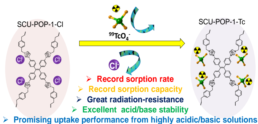
图 2. 新型阳离子骨架材料 SCU-CPN-1 用于分离 \text{TcO}_4^- 。
