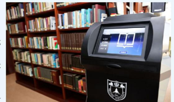
图档博机器人“图宝”是智慧图书馆的馆员，具备引导、图书查询、简单交互咨询等功能。正式投入使用后，“图宝”可以在服务过程中掌握业务应对技巧和行业知识库，同时与图书馆系统形成无缝对接，为读者提供图书信息，成长为智慧化资深机器人馆员。
